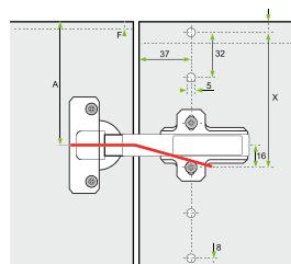
Крепить можно на саморезы, муфты и еврошурпуы. Саморезы являются самым популярным способом крепления из-за простоты.
